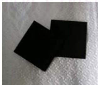
รูปที่ 3.2 ขั้วไฟฟ้าขนาด 5 ตารางเซนติเมตร
