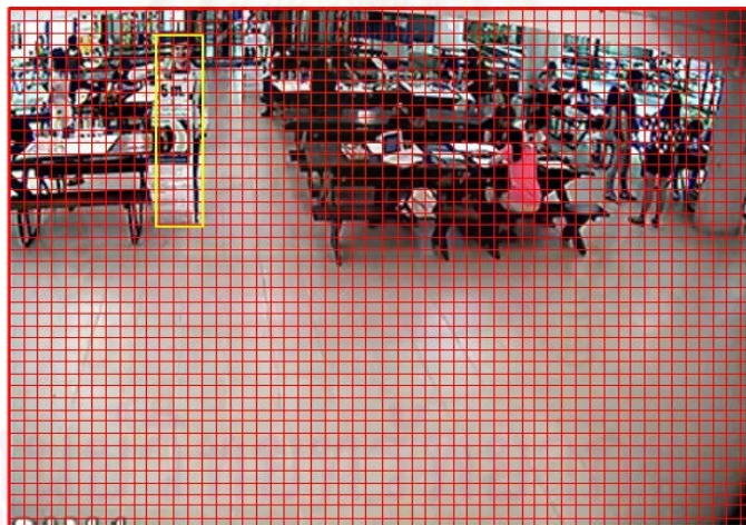
ภาพประกอบ 3.31 การหาความสูงของวัตถุทดลอง กับเลนส์ขนาด 3.5 มม. ตำแหน่งที่ 2
