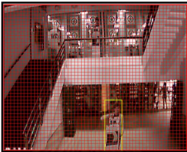
ภาพประกอบ 3.19 การหาความสูงของวัตถุทดลอง กับเลนส์ขนาด 3.5 มม. ตำแหน่งที่ 2
