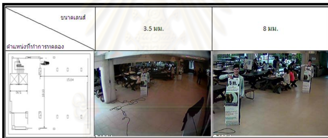
ภาพประกอบ 3.25 . ภาพที่บันทึกได้จริงจากกล้องวงจรปิด บริเวณพื้นที่โรงอาหาร ตำแหน่งที่ 1
