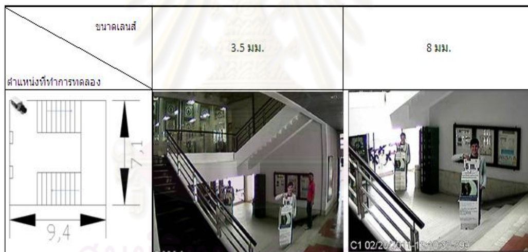
ภาพประกอบ 3.21. ภาพที่บันทึกได้จริงจากกล้องวงจรปิด บริเวณพื้นที่ทางเดินในอาคาร ตำแหน่งที่ 3
