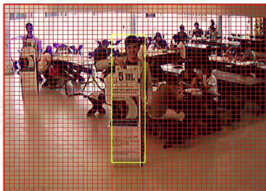
ภาพประกอบที่ 2.11 การหาอัตราส่วนความสูงของวัตถุต่อความสูงของภาพทั้งหมด
