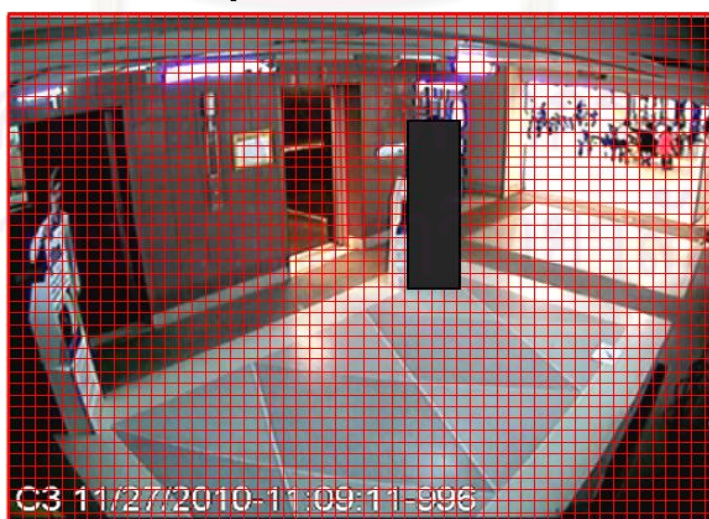
ภาพประกอบ1.9 แสดงการหาขนาดวัตถุในภาพเทียบกับขนาดภาพทั้งภาพ
