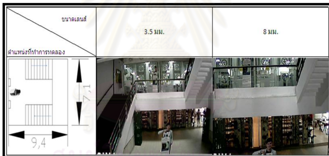
ภาพประกอบ 3.17 ภาพที่บันทึกได้จริงจากกล้องวงจรปิด บริเวณพื้นที่ทางเดินในอาคาร ตำแหน่งที่ 2
