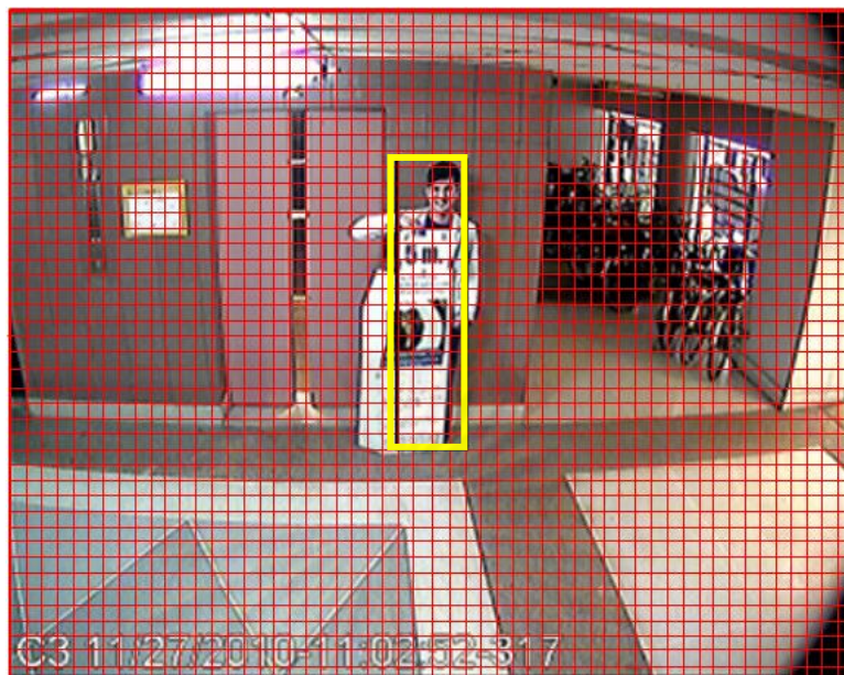
ภาพประกอบ 3.7 การหาความสูงของวัตถุทดลอง กับเลนส์ขนาด 3.5 มม. ตำแหน่งที่ 2
