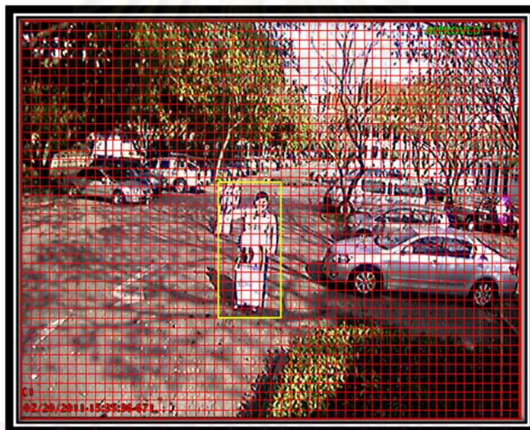
ภาพประกอบที่ 3.71 การหาความสูงของวัตถุทดลอง กับเลนส์ขนาด 3.5 มม. ตำแหน่งที่ 3
