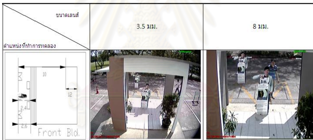
ภาพประกอบที่ 3.53 ภาพที่บันทึกได้จริงจากกล้องวงจรปิด บริเวณพื้นที่ประตูทางเข้าออกคณะ ตำแหน่งที่ 2
