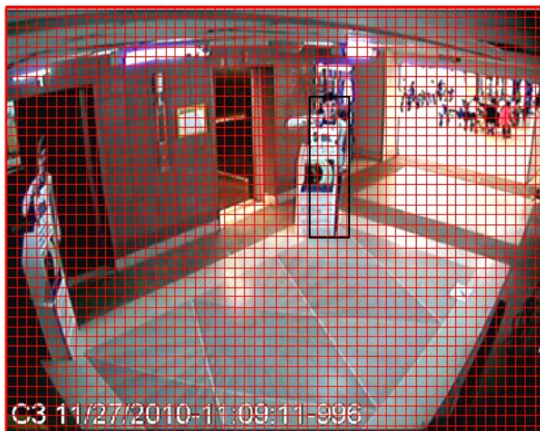
ภาพประกอบ 3.3 การหาความสูงของวัตถุทดลอง กับเลนส์ขนาด 3.5 มม. ตำแหน่งที่ 1
