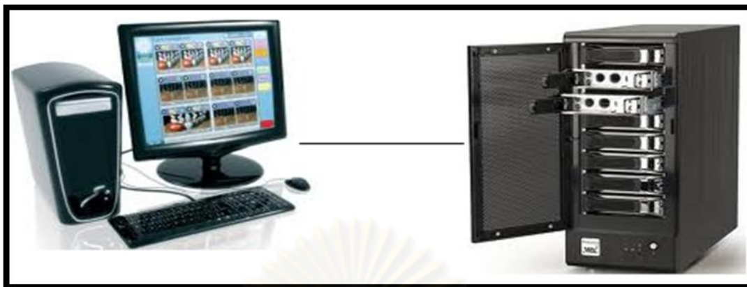
ภาพประกอบ 2.7 ตัวบันทึกภาพ NVR แบบผานโครงข่าย สำหรับ IP Camera
