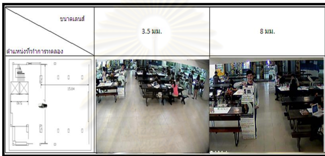
ภาพประกอบ 3.29 ภาพที่บันทึกได้จริงจากกล้องวงจรมืด บริเวณพื้นที่โรงอาหาร ตำแหน่งที่ 2
