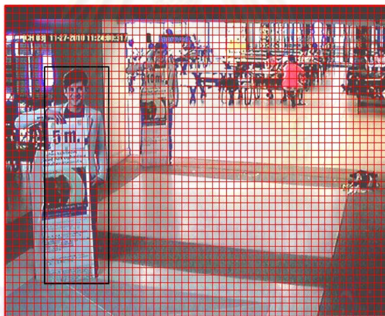
ภาพประกอบ 3.4 การหาความสูงของวัตถุทดลอง กับเลนส์ขนาด 8 มม. ตำแหน่งที่ 1
