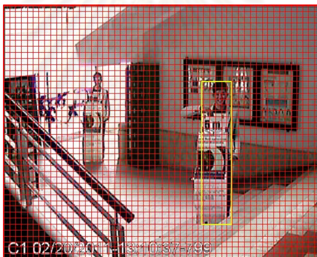
ภาพประกอบ 3.24 การหาความสูงของวัตถุทดลอง กับเลนส์ขนาด 8 มม. ตำแหน่งที่ 3
