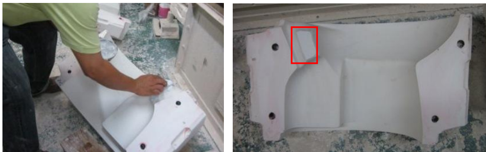
รูปที่ 5.3 ลักษณะของแม่พิมพ์รุ่นBW13 หลังทำการปรับแก้ไข
