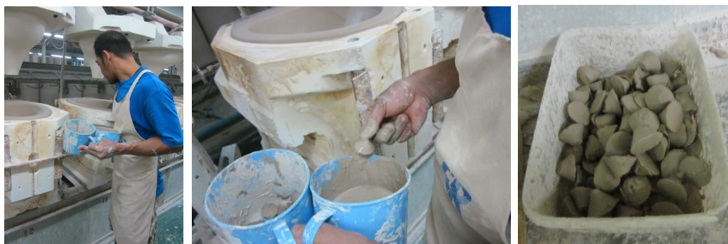
รูปที่ 5.4 วิธีการทำงานของพนักงานในการติดเมล็ดกระดุม
