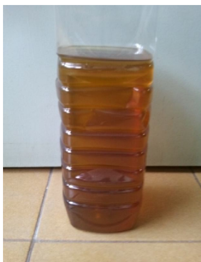
รูปที่ 3.2 น้ำมันที่ผ่านการกรองด้วยกระดาษกรองเบอร์ 42 เส้นผ่านศูนย์กลาง 110 มิลลิเมตร
