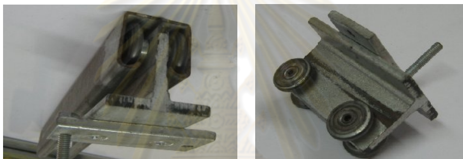
รูปที่ 5.5 รอกสึกจากการเปิดกับราง
