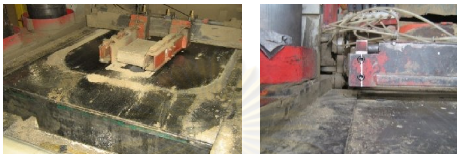
รูปที่ 5.31 Gripper ตัวจับอิฐของเครื่องอัดขึ้นรูป
