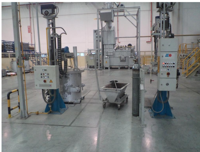
รูปที่ 4.5 เครื่องไล่อากาศออกจากอะลูมิเนียมหลอมเหลวด้วยไนโตรเจน
