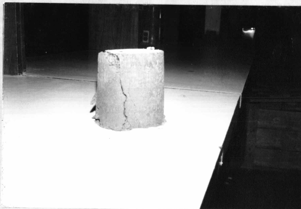
รูปที่ ค.1 ลักษณะการ failure ของผงโลหะผสมที่เมนต์ เมื่อทำการทดสอบเพื่อหาค่า UCS
