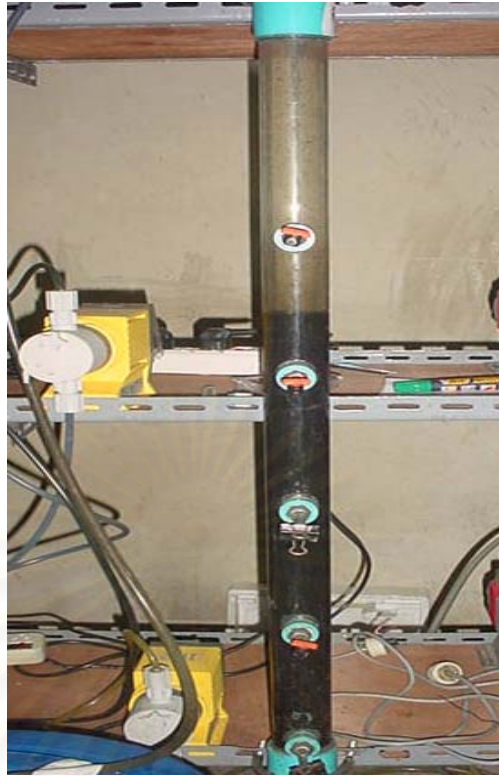
(ก) Q_I : Q_R เท่ากับ 1:11 ความเร็วไหลขึ้น 3.5 ม./ชม.
