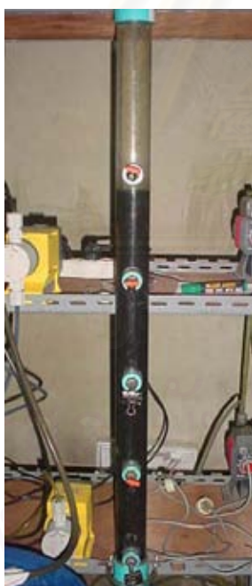
(ค) Q_1 : Q_R เท่ากับ 1:11 ความเร็วไหลขึ้น 4.5 ม./ชม. (ง) Q_1 : Q_R เท่ากับ 1:15 ความเร็วไหลขึ้น 4.5 ม./ชม.
