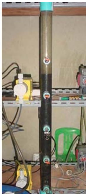
(ก) Q_1 : Q_R เท่ากับ 1:3 ความเร็วไหลขึ้น 4.5 ม./ชม. (ข) Q_1 : Q_R เท่ากับ 1:7 ความเร็วไหลขึ้น 4.5 ม./ชม.
