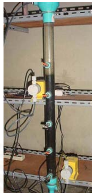
(ก) Q_1 : Q_R เท่ากับ 1:3 ความเร็วไหลขึ้น 4.5 ม./ชม. (ข) Q_1 : Q_R เท่ากับ 1:7 ความเร็วไหลขึ้น 4.5 ม./ชม.
