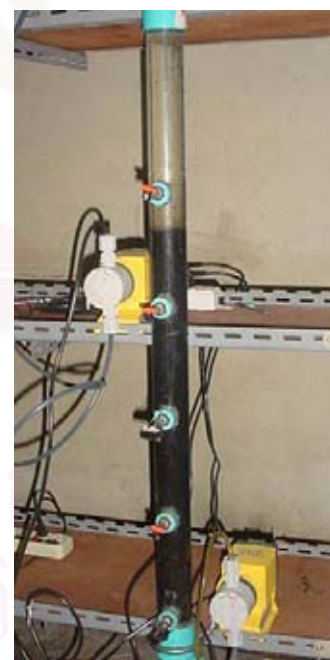
(ค) Q_1 : Q_R เท่ากับ 1:11 ความเร็วไหลขึ้น 4.5 ม./ชม. (ง) Q_1 : Q_R เท่ากับ 1:15 ความเร็วไหลขึ้น 4.5 ม./ชม.
