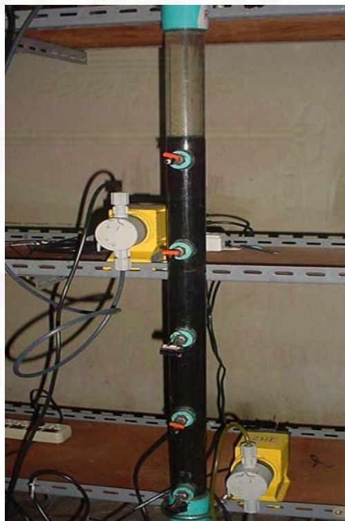
(ข) Q_I : Q_R เท่ากับ 1:11 ความเร็วไหลขึ้น 5.5 ม./ชม.
