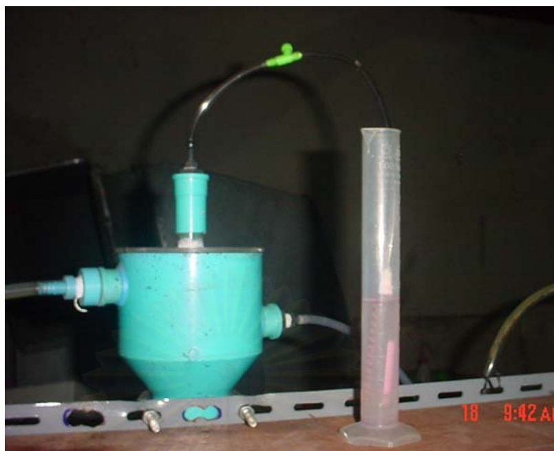
รูปที่ 3.4 การติดตั้งอุปกรณ์วัดก๊าซ
