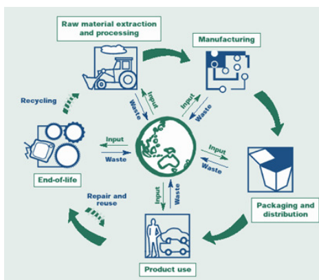
ภาพที่ 2.10 ตัวอย่างการประเมินวัฏจักรชีวิตผลิตภัณฑ์รถยนต์
