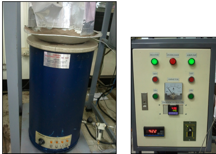
ภาพที่ 3.1 อ่างทรายฟลูอิดส์สำหรับให้ความร้อน และแผงควบคุมอุณหภูมิ
