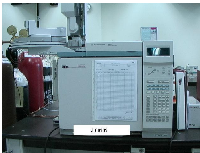
ภาพที่ 3.5 เครื่องแก๊สโครมาโทกราฟีจำลองการกลั่น (Distillation Gas Chromatograph, DGC)
