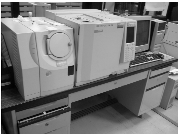
ภาพที่ 3.4 เครื่องแก๊สโครมาโทกราฟี แมสสเปกโตรมิเตอร์ (Gas chromatography-mass spectrometry, GC-MS)
