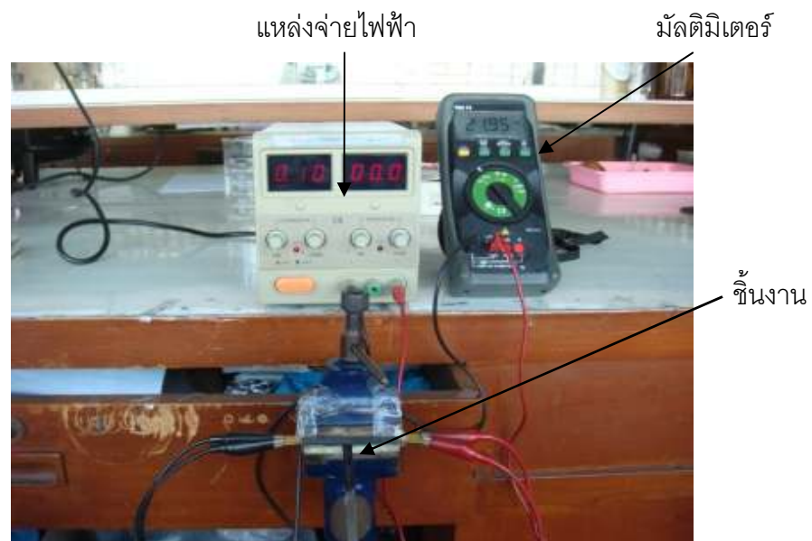
ภาพที่ 3.3 เครื่องมือการวัดค่าความต้านทานเชิงสัมผัส [20]
