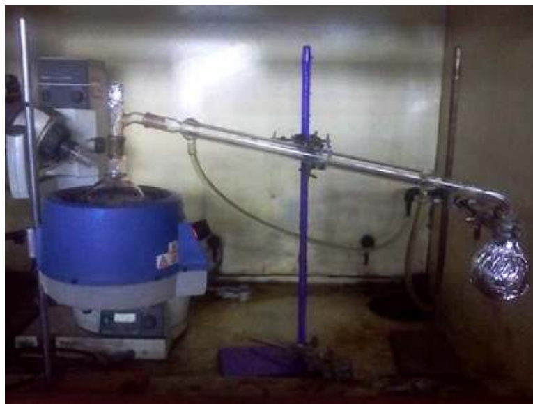
ภาพที่ 3.1 การติดตั้งอุปกรณ์การกลั่นมอโนเมอร์
