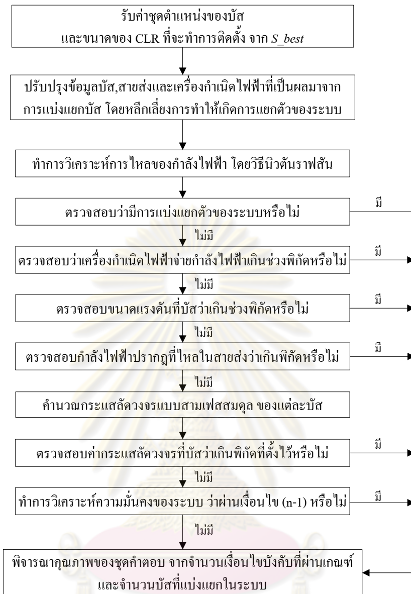
รูปที่ 4.14 แผนผังแสดงอัลกอริทึมการวิเคราะห์คุณภาพคำตอบของกรณีประยุกต์ใช้วิธีแบ่งแยกบัส
