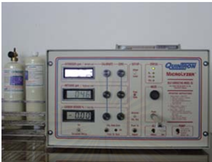
ภาพที่ 14: แสดงภาพถ่ายของเครื่อง gas chromatography สำหรับตรวจวัดความเข้มข้นของแก๊สไฮโดรเจน
