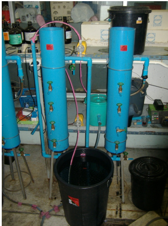
รูปที่ 3-2 ถังกรองไร้ออกซิเจนที่ใช้ในงานวิจัย (ภาพแสดง 1 ชุดการทดลอง)
