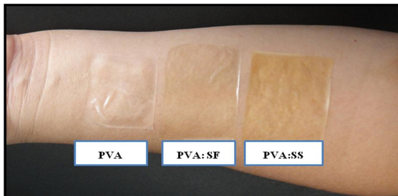
รูปที่ 4.2 ลักษณะไฮโดรเจลที่เตรียมได้จากการผสมระหว่าง PVA กับ SF/SS
