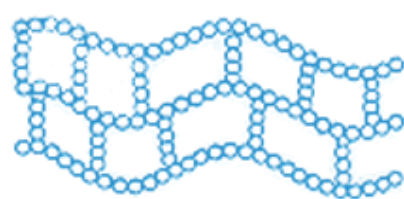
รูปที่ 2.3 โครงสร้างพอลิเมอร์แบบร่างแห [10]
