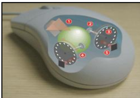
ภาพที่ 2.4 ลักษณะการทำงานของเมาส์แบบกล (สหัชญา บุญสวัสดิ์, 2543)
