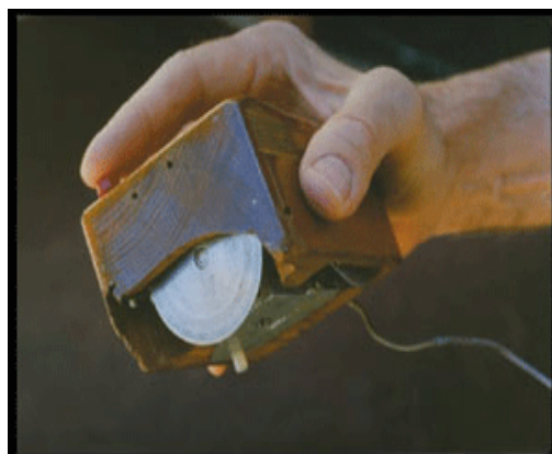
ภาพที่ 2.3 การทำงานล้อหมุนของเมาส์
