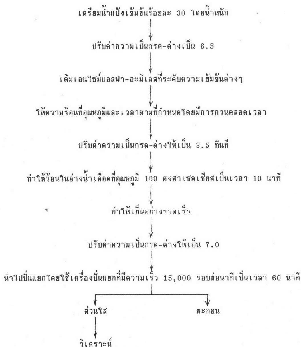
ภาพที่ 2 : กระบวนการผลิตมอลโตเดกซ์ทรินโดยการเติมเอนไซม์ครั้งเดียวในการผลิตแบบกะ
