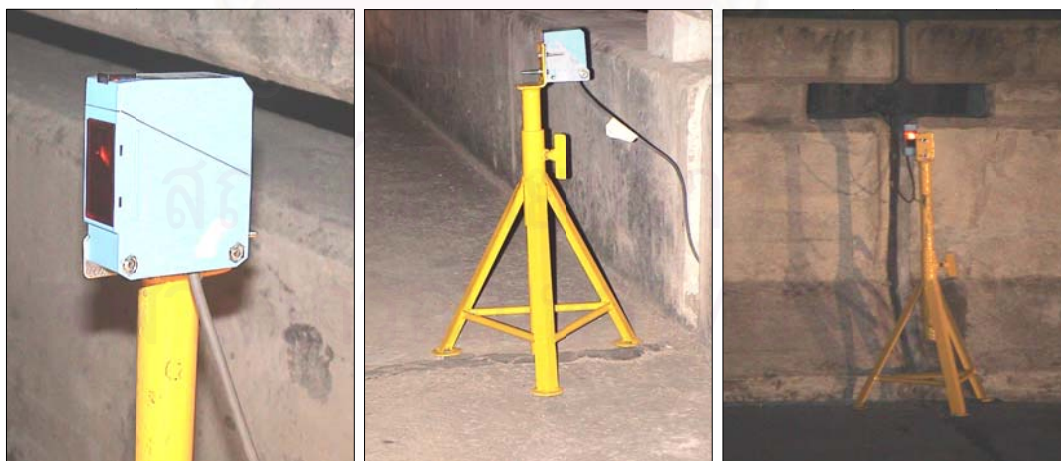
รูปที่ 5.11 เซ็นเซอร์บอกตำแหน่งรถบรรทุก 1. ลักษณะทั่วไป 2. ตัวรับสัญญาณ 3. ตัวส่งสัญญาณ
