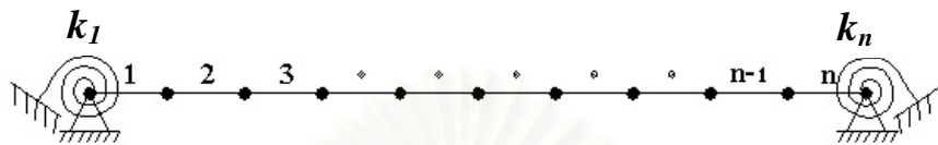
รูปที่ 2.6 รูปแบบการแบ่งชิ้นส่วนของแบบจำลองสะพาน (แสดงเฉพาะสะพานช่วงที่ 1)
