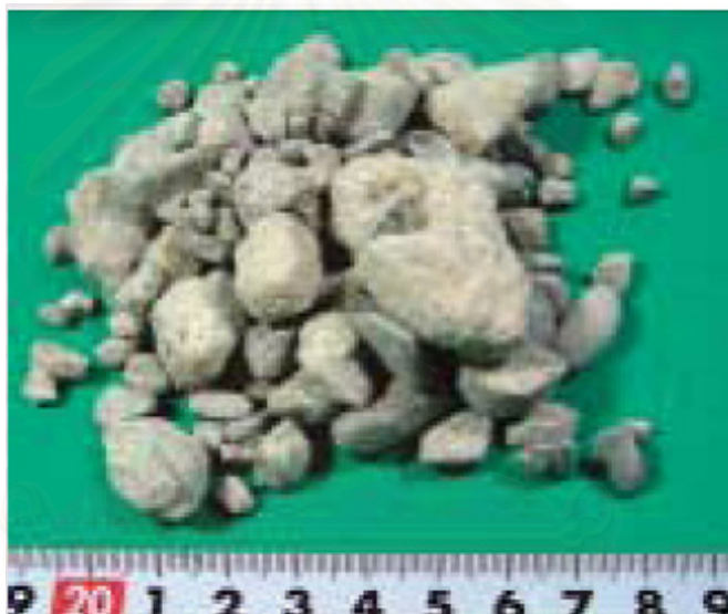
รูปที่ 3.10 มวลรวมหยาบสำหรับผสมคอนกรีต (Coarse Aggregate) ที่ได้จากคอนกรีต (ที่มา: Itoh and Liu, 2006)
