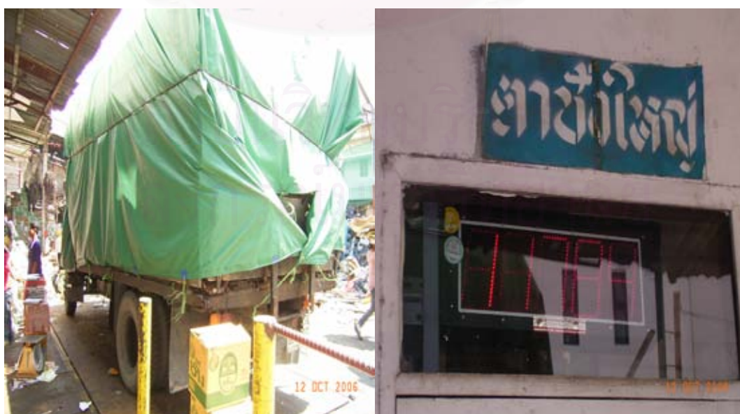
รูปที่ 4.16 การชั่งน้ำหนักเหล็กเสริมคอนกรีตก่อนส่งโรงงานหลอมเหล็ก
