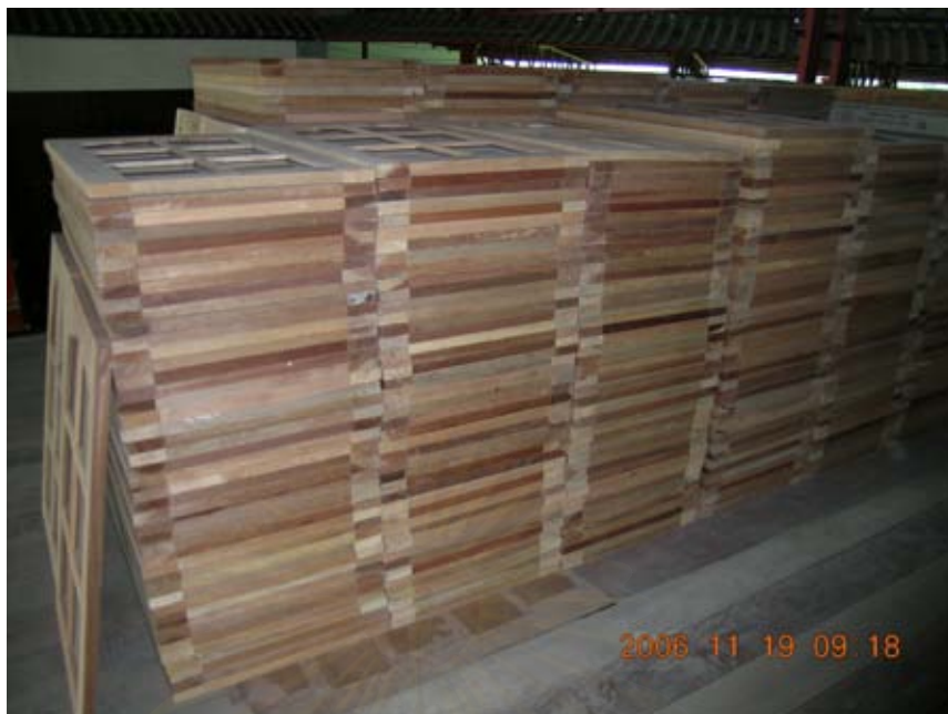
รูปที่ 4.34 หน้าต่างที่ได้จากการแปรรูปไม้ที่เกิดจากการรีไซเคิลของสิ่งก่อสร้าง
