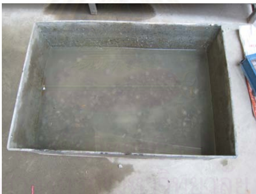
รูปที่ 5.24 การนำมวลรวมหยาบ (Coarse Aggregate) แฉ่น้ำตามชั้นตอที่กำหนด
