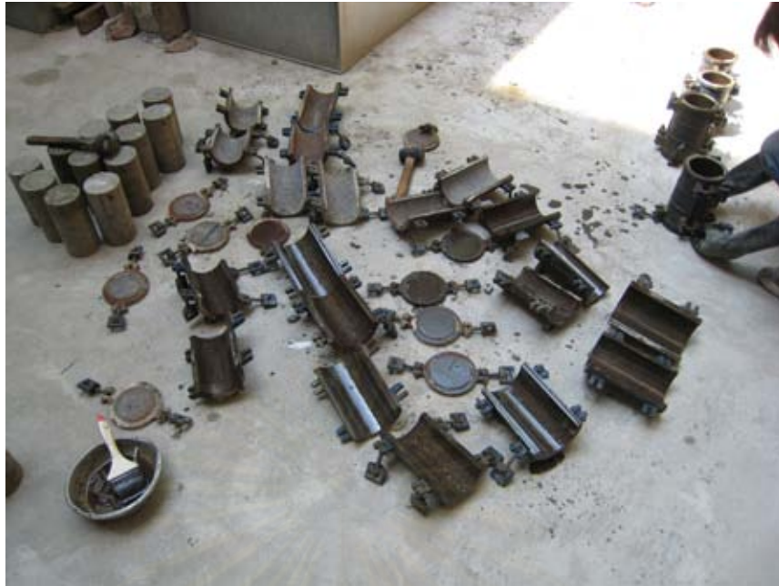
รูปที่ 5.31 การถอดแบบหล่อก้อนตัวอย่างคอนกรีต
