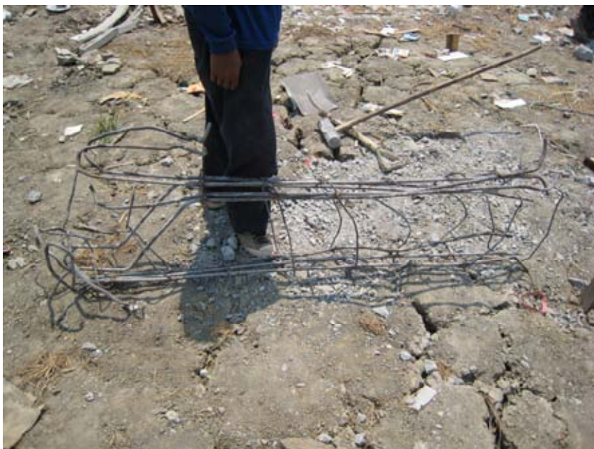
รูปที่ 5.6 เหล็กเสริมคอนกรีตที่ได้จากการทุบย่อยคานคอนกรีต
