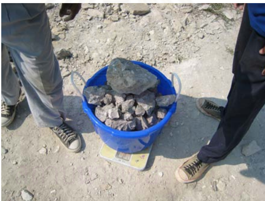
รูปที่ 5.7 การชั่งน้ำหนักเศษคานคอนกรีตที่เกิดจากการทุบย่อย
