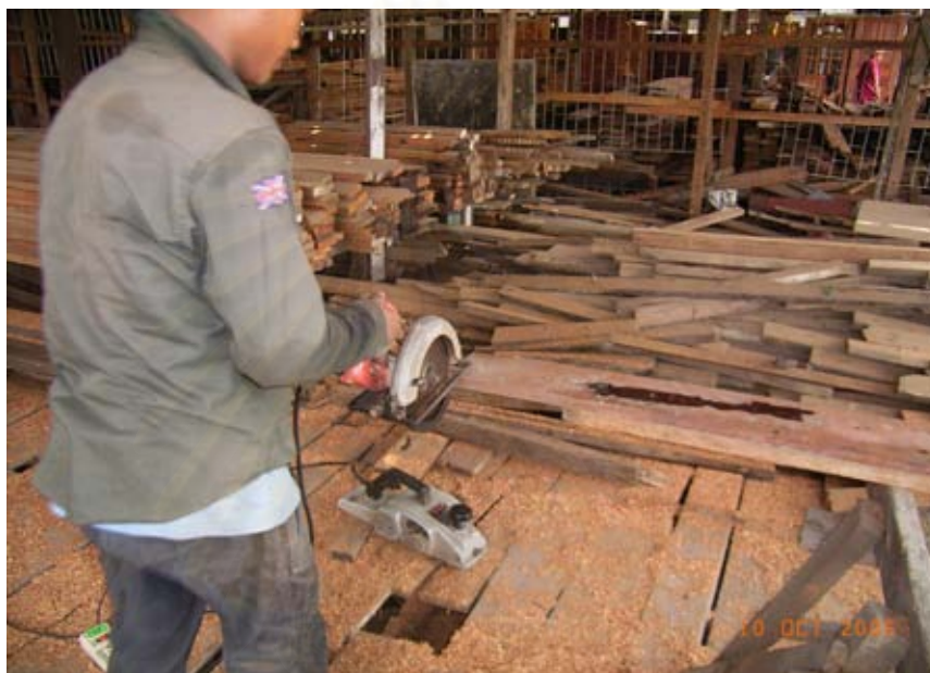
รูปที่ 4.29 การตกแต่งไม้ที่เกิดจากการรื้อถอนสิ่งก่อสร้างโดยการตัดปลายไม้
