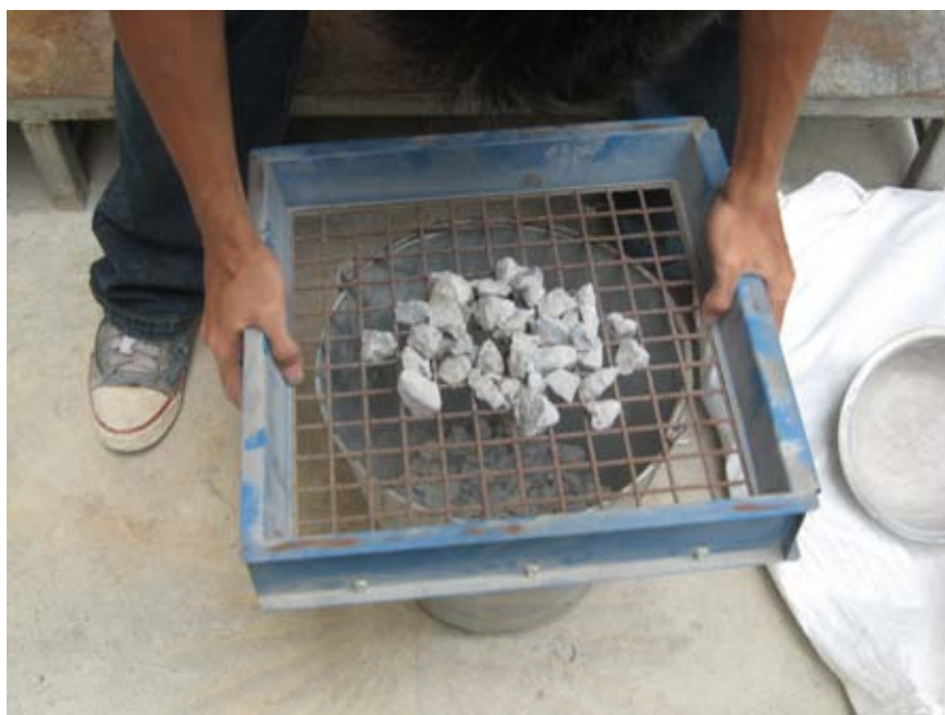
รูปที่ 5.23 มวลรวมหยาบ (Coarse Aggregate) ที่ได้จากการบดย่อยเศษคอนกรีตที่เกิดจากการรื้อถอนสิ่งก่อสร้างผ่านตะแกรงขนาด 1”
