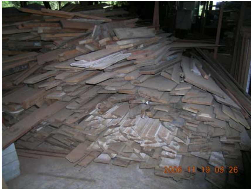
รูปที่ 4.32 ไม้ที่เกิดจากการรื้อถอนสิ่งก่อสร้างก่อนนำมาแปรรูปเป็นวัสดุใช้สอย
