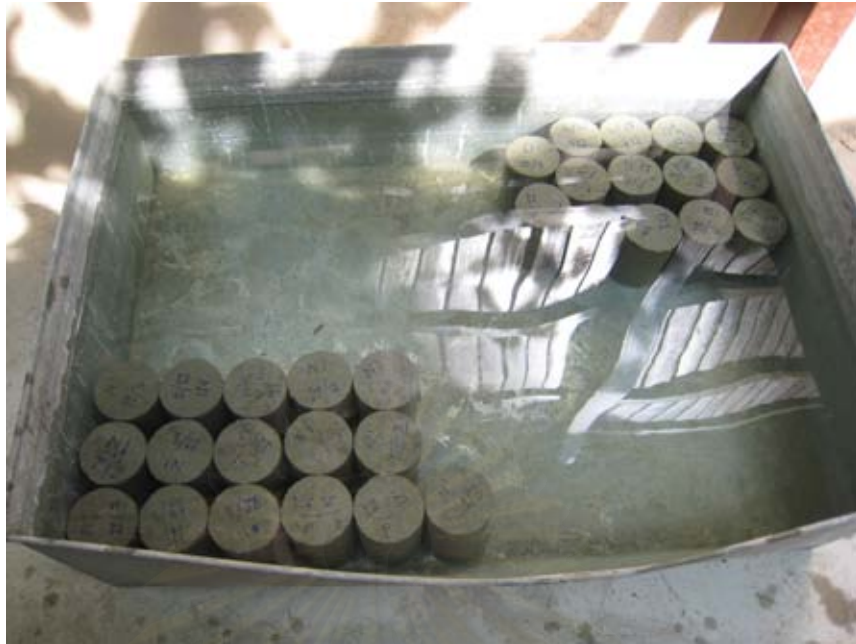
รูปที่ 5.33 การบ่มคอนกรีต
