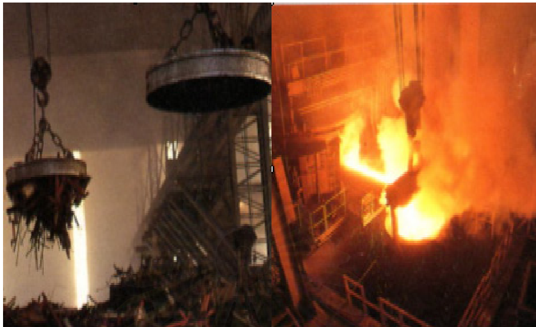
รูปที่ 4.17 การนำเหล็กเข้าเตาหลอมและการหลอมเหล็ก
