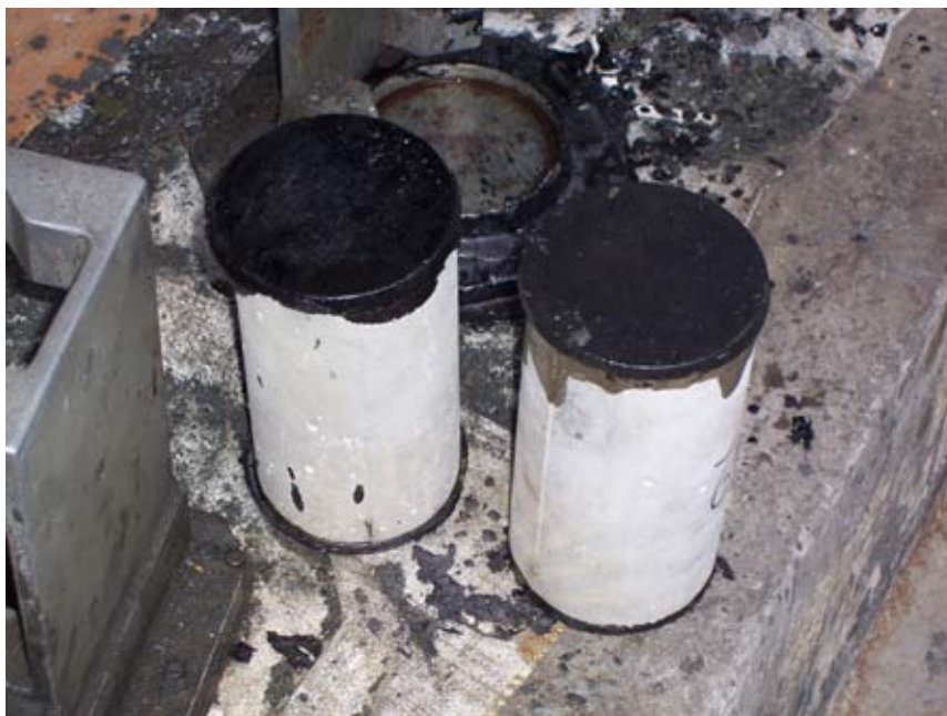
รูปที่ 5.35 การหุ้มหัว (Cap) ก้อนตัวอย่างเพื่อให้ผิวหน้าเรียบก่อนการทดสอบ
