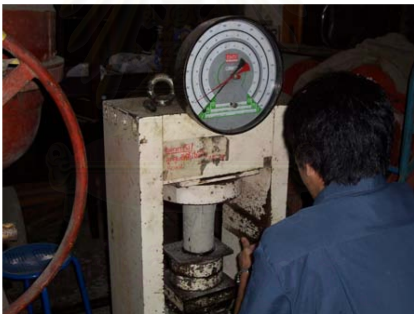
รูปที่ 5.36 การนำก้อนตัวอย่างเข้าเครื่องทดสอบเพื่อทดสอบกำลังอัดของคอนกรีต
