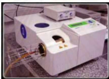
รูปที่ 3.4 เครื่องวิเคราะห์เชิงความร้อนรุ่น TGA/SDTA 851° ของ Mettler Toledo
