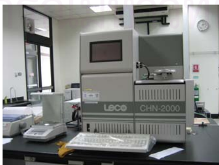
รูปที่ 3.5 เครื่อง CHN Element analysis รุ่น CHN-2000 ของ LECO
