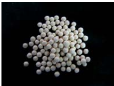
รูปที่ 3.2 ซีโอไลต์ 3เอ ที่ใช้ในการทดลอง
