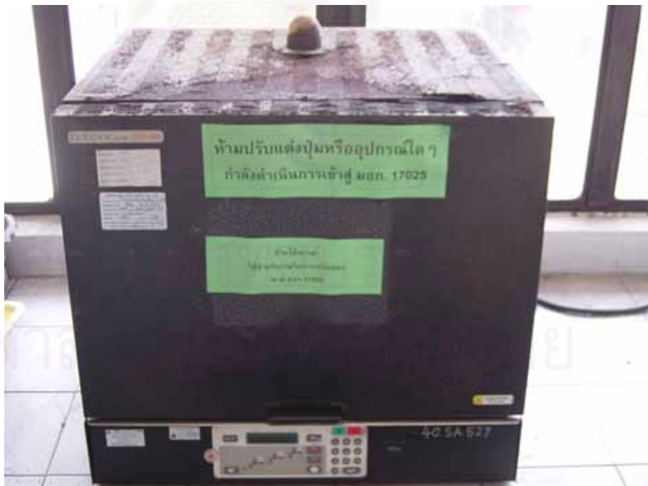
รูปที่ 3.2 เตาเผาอุณหภูมิสูง (Muffle furnace)
