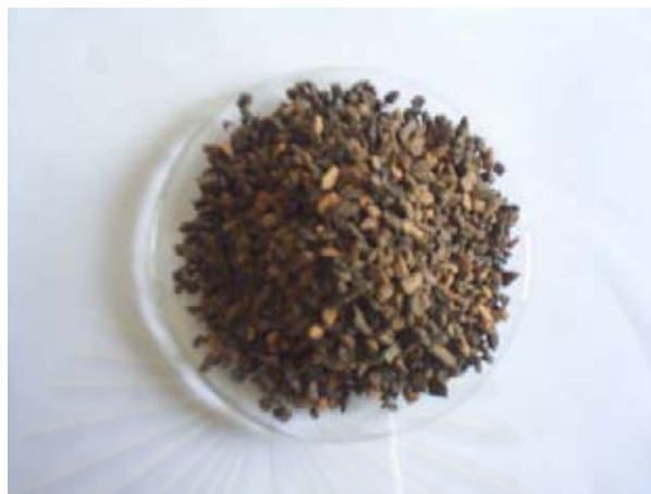
รูปที่ 4.2 ถ่านกระดูก บดคัดขนาด 8 - 16 เมช
