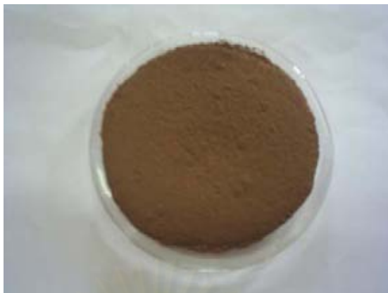
รูปที่ 4.7 ถ่านกระดูกบด ขนาดน้อยกว่า 325 เมช สัดส่วน ซิงค์คลอไรด์ต่อกระดูกบด เป็น 2 :1 โดยน้ำหนัก
