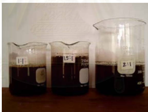
รูปที่ 4.3 ถ่านกระดูกบดแช่ในสารละลายซิงก์คลอไรด์
