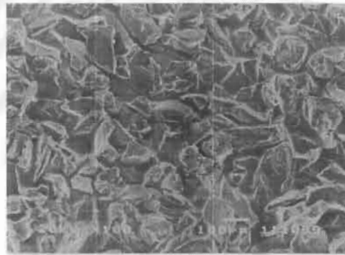
รูปที่ 42 แสดงลักษณะพื้นผิวของฐานแบรคเกตเซรามิก Transcend series 6000 (กำลังขยาย 100 เท่า) ซึ่งประกอบด้วยผลึกรูปร่างไม่แน่นอนกระจายอยู่ทั่วไปบนพื้นผิว
