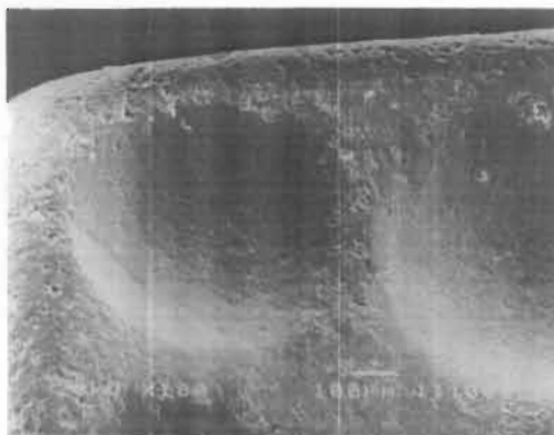
รูปที่ 47 แสดงลักษณะหลุมของแบรคเกตเซรามิก Crystalline ซึ่งเป็นแอ่งรูปกะทะหงายลักษณะโค้งมน
