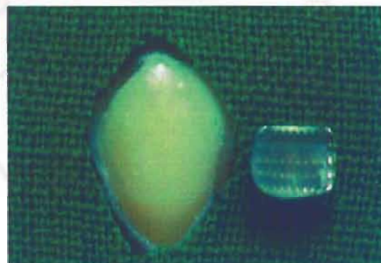
รูปที่ 40 ภาพแสดงบริเวณที่เกิดความล้มเหลวในการยึดติดระหว่างผิวเคลือบฟัน และวัสดุยึด
