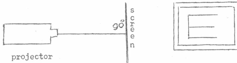
ภาพที่ ๓๐ แสดงการตั้งเครื่องฉายให้ตรงกับจอ
