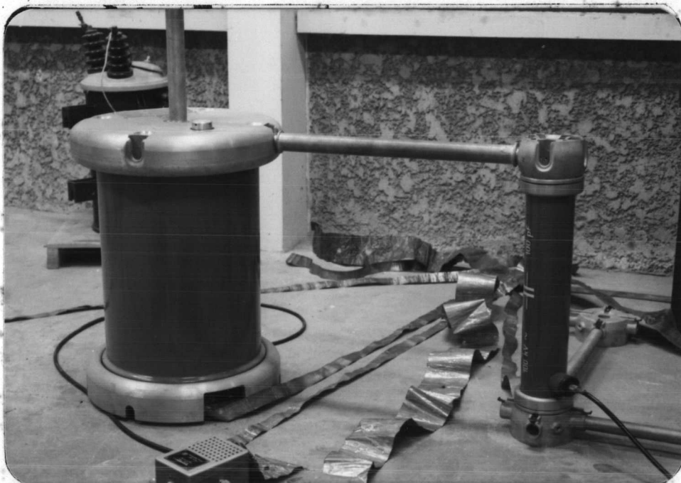
รูป 4.7 หม้อแปลงป้อนแรงดันทดสอบพร้อมระบบวัดแรงดัน
