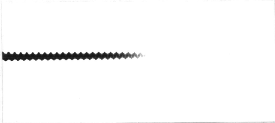
รูปที่ 4.21 แสดงการถ่ายภาพสารรังสีอิริเดียม-192 ด้วยรังสีเอกซ์
