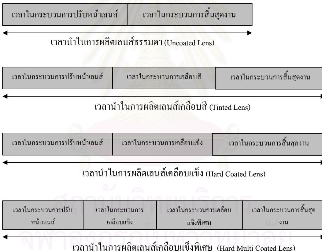
รูปที่ 3.3 องค์ประกอบของเวลามาในการผลิตเลนส์แต่ละประเภท
