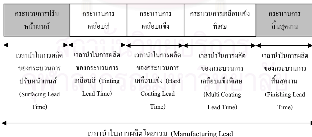
รูปที่ 8.2 ความหมายของเวลานำแต่ละกระบวนการผลิตหลัก และเวลานำในการผลิตโดยรวม
