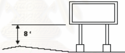
รูปที่ 2.16 การติดตั้งแผ่นป้ายคร่อมไหล่ทาง
