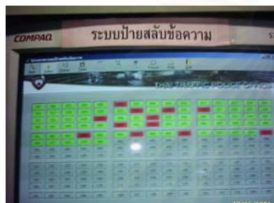
รูปที่ 2.24 คอมพิวเตอร์ที่มีการติดตั้งระบบตรวจสอบสถานะของป้ายจราจรสลัข้อความ
