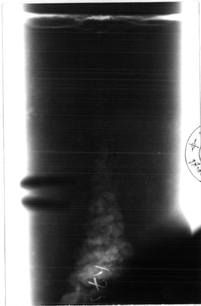
รูปที่ 4.5 ภาพถ่ายเนื้อในแท่งดินระเบิด (T.N.T.) หน้า 2\frac{1}{2} นิ้ว
