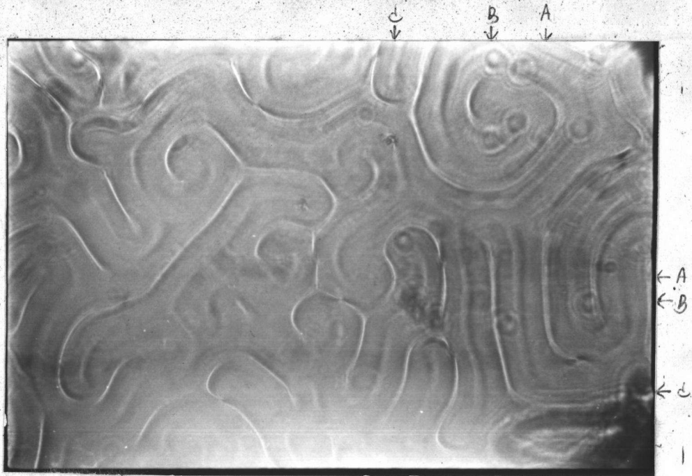
รูปที่ 4-30 เทกซ์เจอร์ของ MBBA/CN 0.398 \pm 0.003\% ที่อุณหภูมิ 40.6^{\circ} C ความหนา 25 ไมครอน กำลังขยาย 10X20 ไมโครโพลาริเซอร์
