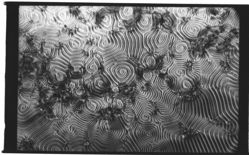
รูปที่ 4-21. เทกซ์เจอร์ลายก้นหอยของ MBBA /CN 2.35 \pm 0.03\% ที่อุณหภูมิ 38.8^{\circ}\text{C} ความหนา 25 ไมครอน กำลังขยาย 10x20 ครอสโพลารอยด์
