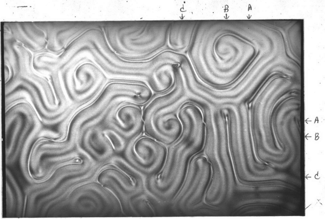
รูปที่4-28 เทกซ์เจอร์ของ MBBA/CN 0.398 \pm 0.003\% ที่อุณหภูมิ 40.6^{\circ}\text{C} ความหนา 25 ไมครอน กำลังขยาย 10 \times 20 โพลารอยด์ทำมุมกัน 0 องศา
