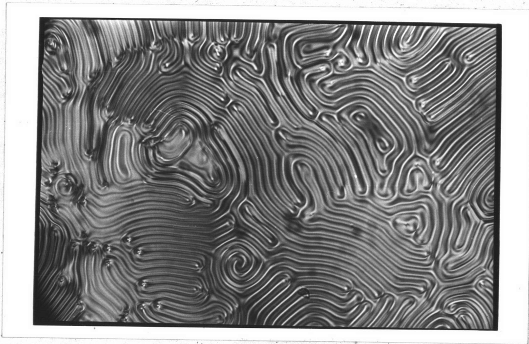
รูปที่ 4-3 เทกซ์เจอร์ของ MBBA / CP / Toluene 0.589 \pm 0.004\% ที่อุณหภูมิ 36.8^{\circ}\text{C} ความหนา 25 ไมครอน กำลังขยาย 10 \times 20 ครอสโพลารอยด์ สไลด์ที่ 2
