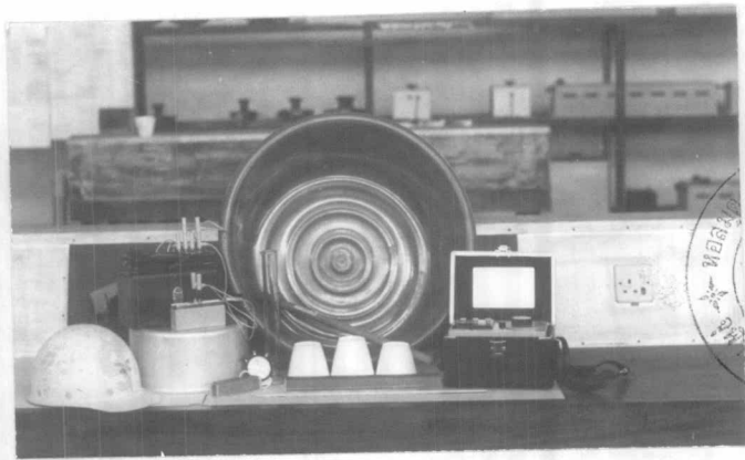
รูปที่ ๓.๔ เครื่องมือและอุปกรณ์ที่ใช้ในการวัดค่าความต้านทานจำเพาะ ของน้ำฝน
