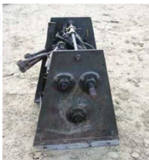
ภาพที่ 4.2.2.3.4 ชุดอุปกรณ์รอกและเพลาลูก สำหรับใช้ในการยกส่วนยอดของเมรุ
