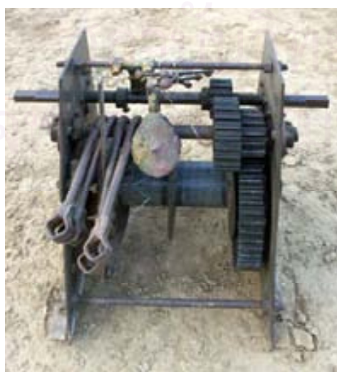
ภาพที่ 4.2.2.3.4 ชุดอุปกรณ์รอกและเพลาลูก สำหรับใช้ในการยกส่วนยอดของเมรุ
