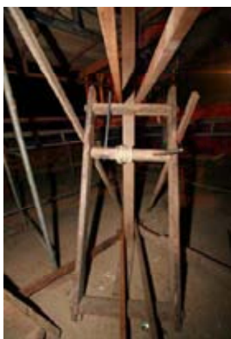
ภาพที่ 4.2.4.3.3 เพลา สำหรับใช้ในการยกส่วนยอดของเมรุประธาน
