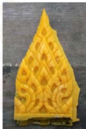
ภาพที่ ข.6 กระจกหล่อเรซินจากแม่พิมพ์ยางพารา
