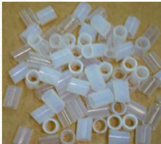
รูปที่ 3.3 คอลัมน์หอกกลั่น และแพคกิง (packing)
