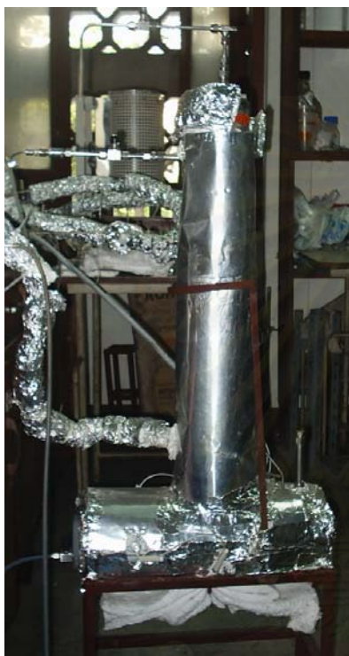
รูปที่ 3.3 คอลัมน์หอกกลั่น และแพคกิง (packing)
