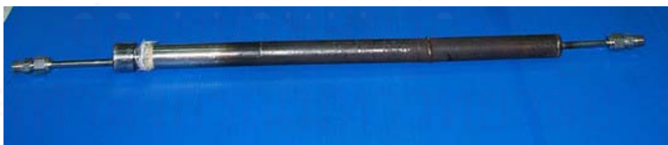
รูปที่ 3.2 เครื่องปฏิกรณ์คายความร้อน
