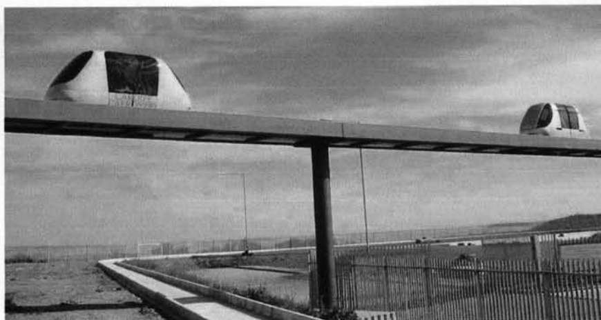
รูปที่ 2.8 แสดงรางทดลองระบบคมนาคมขนส่งส่วนบุคคล โดยบริษัทอัลตรา 10
