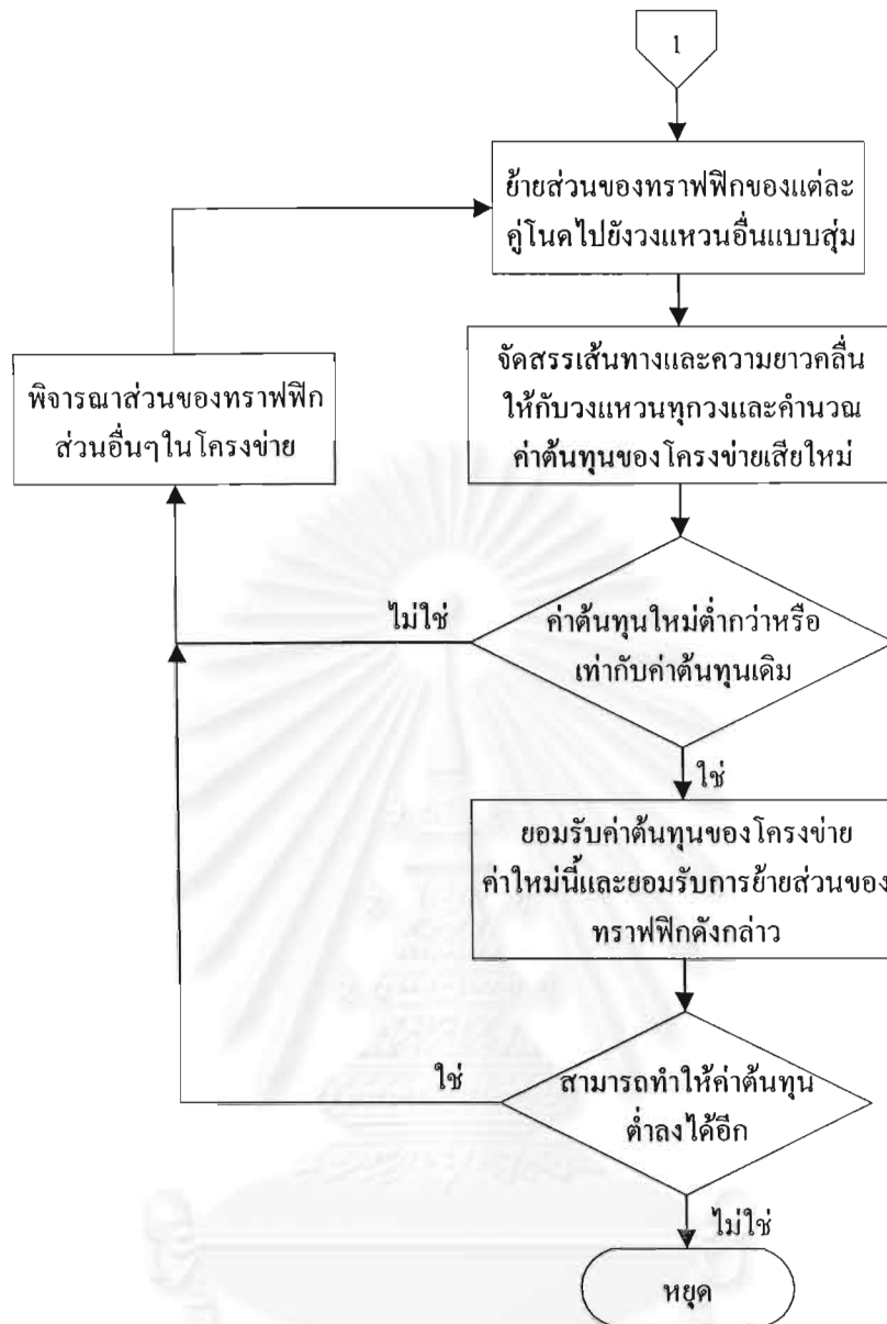
รูปที่ 5.1 แผนผังการทำงานของอัลกอริทึมสำหรับการออกแบบโครงข่ายใยแก้วนำแสงแบบหลายความยาวคลื่นโดยใช้โครงข่ายแบบวงแหวนหลายวงด้วยวิธี heuristic
