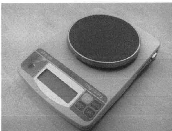
ภาพที่ 3.4 แสดงเครื่องชั่งระบบ Digital รุ่นทศนิยม 2 ตำแหน่ง ขนาด 120 g.
