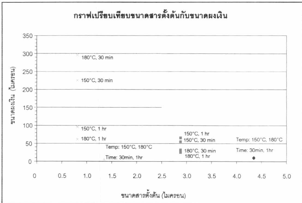
รูปที่ 4.15 กราฟเปรียบเทียบขนาดผงเงินเฉลี่ยกับขนาดสารตั้งต้นเฉลี่ย
