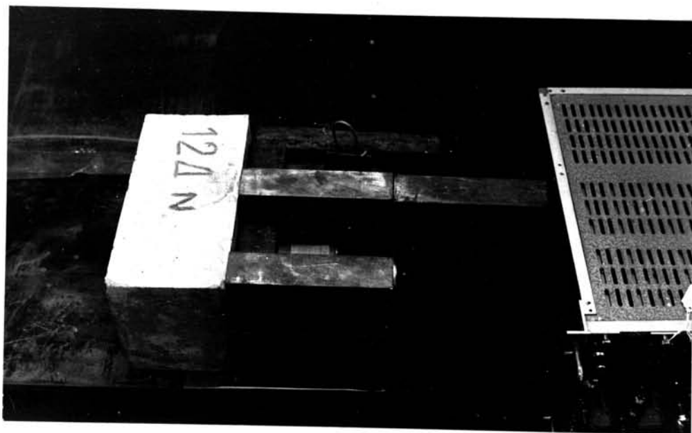
รูปที่ 5.1 แสดงการวัดปริมาณรังสีสะท้อนจากคอนกรีต ในห้องปฏิบัติการ
