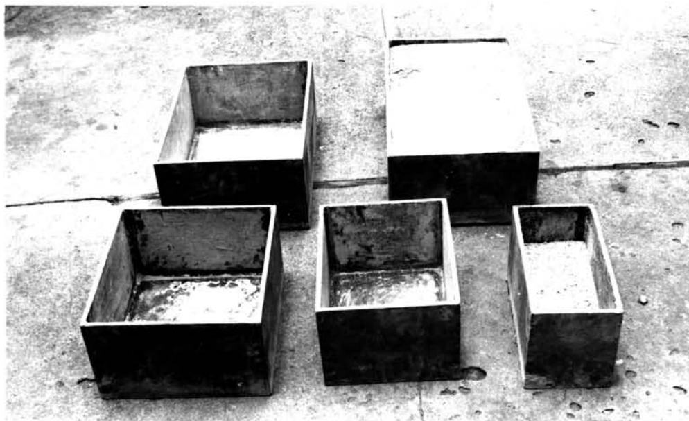
รูปที่ 2.23 ภาชนะที่ใช้สำหรับบรรจุสารเพื่อจะหาความหนาสูงสุด ของสารที่จะนำมาวัดความหนาแน่น
