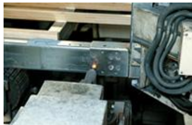
รูปที่ 3.4 เชื่อมเสากับคานภายในโรงงาน
