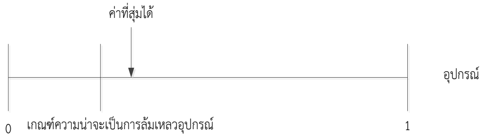
ภาพที่ 5.2 วิธีการสุ่มสถานการณ์ทำงานของแต่ละอุปกรณ์
