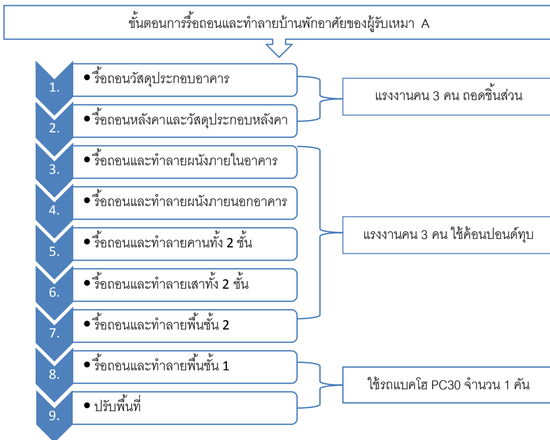
รูปที่ 4.10 สรุปขั้นตอนการรื้อถอนและทำลายบ้านพักอาศัยของผู้รับเหมา A
