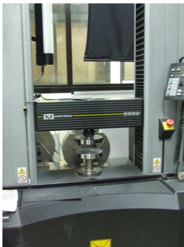
ภาพที่ 3.9 เครื่อง Universal Testing Machines รุ่น 5882
