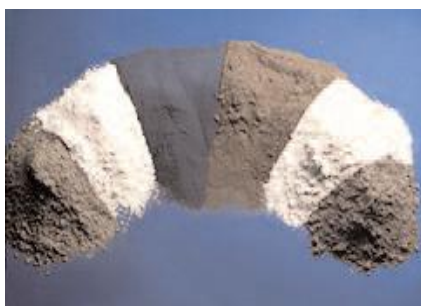
ภาพที่ 2.8 วัสดุปอซโซลานชนิดต่างๆ เรียงจากซ้ายไปขวา เถ้าลอย(Class C) ดินขาวเผา ซิลิกาฟุ้ง เถ้าลอย(Class F) ตะกรันและหินดินดานเผา (8)
