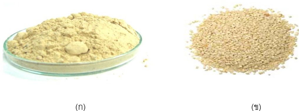
ภาพที่ 2.2 (ก) ยิปซัมฟลูแก๊ส(Flue-gas gypsum) และ(ข) ฟอสฟอยิปซัม(Phosphogypsum) (1, 4)
