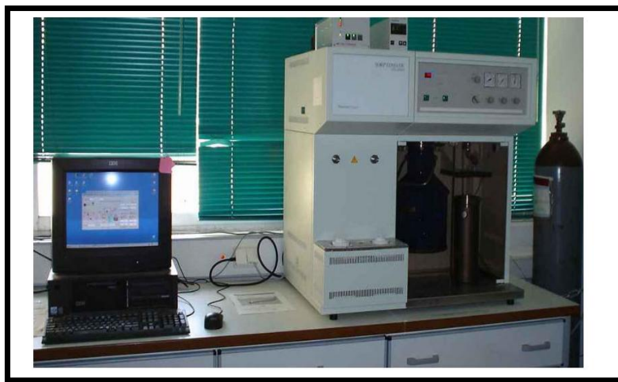
ภาพที่ 3.6 เครื่องวิเคราะห์หาพื้นที่ผิวรูพรุนทั้งหมด (BET surface area)
