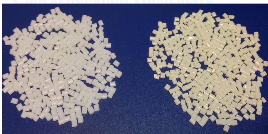
ภาพที่ 8 แสดงเม็ดพลาสติกชนิด HIPS (ซ้าย) เปรียบเทียบกับเม็ดพลาสติกชนิด ABS (ขวา)
