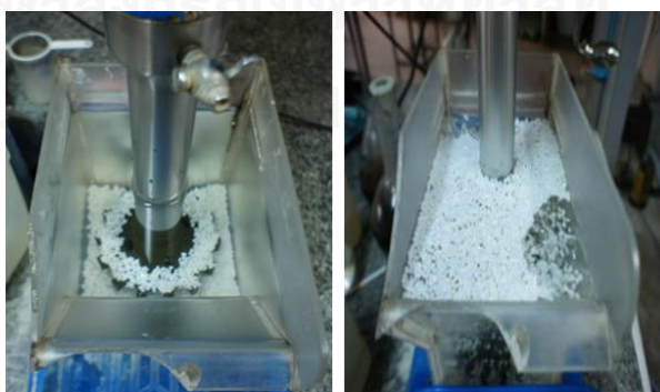
ภาพที่ 43 แสดงเม็ดพลาสติกทั้งสองชนิดที่จมตัวในน้ำ (ซ้าย) แต่เมื่อเปิดเครื่อง Flotation พร้อมกับเป่าฟองอากาศก็จะลอยตัวขึ้นบนผิวน้ำ (ขวา)
