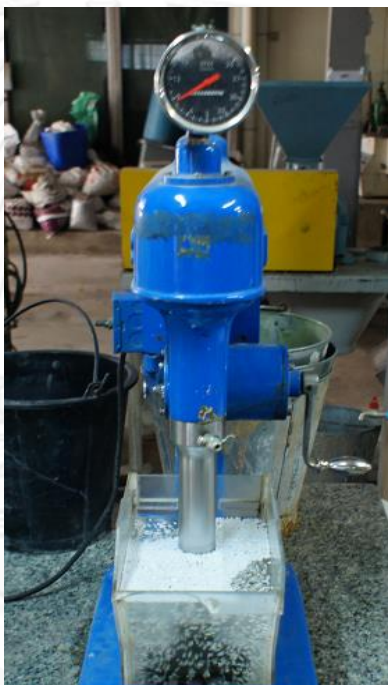
ภาพที่ 15 แสดงเครื่องลอยแร่ที่ใช้ในงานวิจัยนี้
