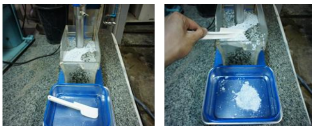
ภาพที่ 36 แสดงลักษณะการลอยของเม็ดพลาสติกเมื่อผ่านฟองอากาศเข้าไปในระบบ และการกวาดส่วนที่ลอย
