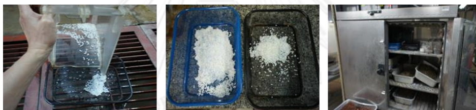
ภาพที่ 37 แสดงการอบไล่ความชื้นเม็ดพลาสติกที่ผ่านการลอยแยก
