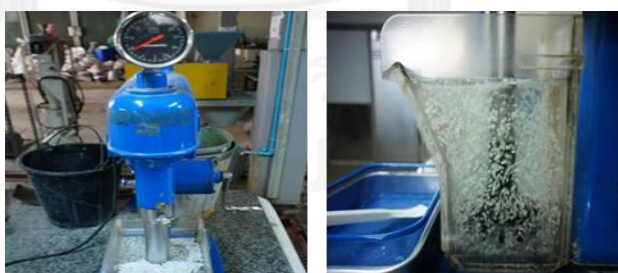
ภาพที่ 35 การการวนของเครื่อง Flotation และการกระจายตัวของเม็ดพลาสติกเมื่อเปิดเครื่อง
