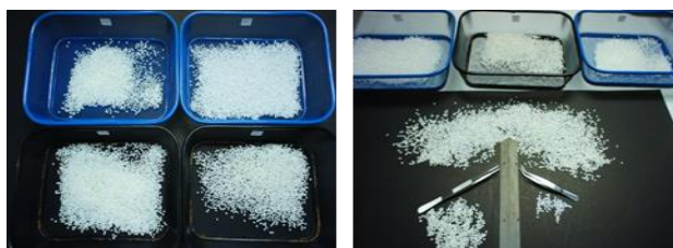
ภาพที่ 38 แสดงเม็ดพลาสติกชนิด ABS และ HIPS หลังผ่านการคัดแยกด้วยมือ
