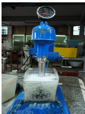
ภาพที่ 29 แสดงเครื่องลอยแร่แบบกลไกที่ใช้ในการวิจัยนี้
