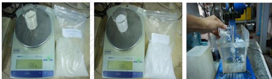
ภาพที่ 34 การเตรียมตัวอย่างเม็ดพลาสติกผสมระหว่าง ABS และ HIPS อย่างละ 50 กรัมลงในเซลล์ลอยแยก
