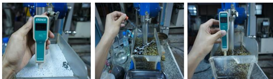
ภาพที่ 40 แสดงการวัดค่า pH ของสารละลายตัวกลางด้วย pH meter และสีของสารละลายตัวกลางที่เปลี่ยนไปหลังจากการหยดสารละลายโซเดียมไฮดรอกไซด์
