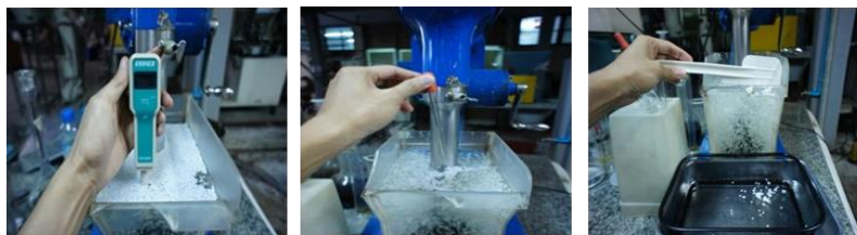
ภาพที่ 41 แสดงการวัดค่า pH ของสารละลายตัวกลาง การหยดน้ำมันสน และการกวาดเอาเม็ดพลาสติกส่วนที่ลอยออกจากระบบ
