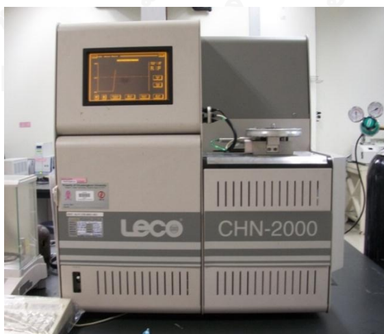
รูปที่ 3.3 เครื่องวิเคราะห์แบบแยกธาตุ (CHN analyzer)
