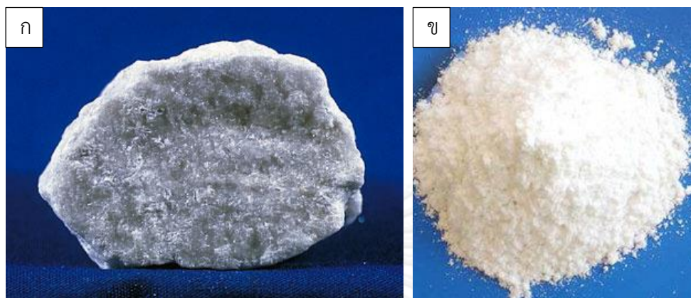
รูปที่ 2.6 ลักษณะทางกายภาพของ (ก) แร่ยิปซัม [10], (ข) แคลเซียมซัลเฟต [11]
