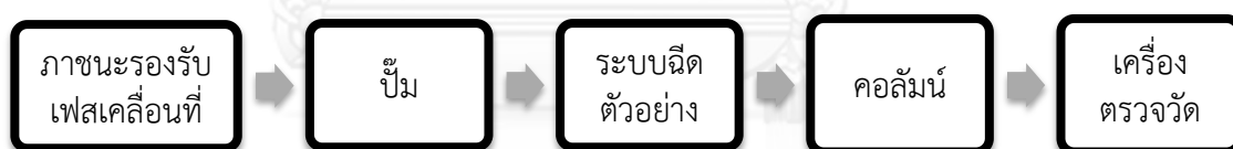
รูปที่ 2.6 แผนภาพอุปกรณ์ HPLC
