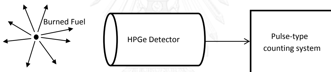
รูปที่ 3.1 แผนผังการทดลองวัดรังสีแกมมาจากแท่งเชื้อเพลิงใช้แล้ว
