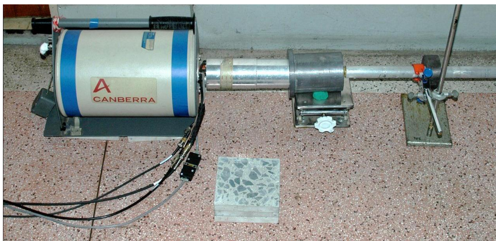
รูปที่ 3.7 หัววัดรังสี HPGe ที่ใช้สอบเทียบประสิทธิภาพของระบบวัดรังสีแกมมา
