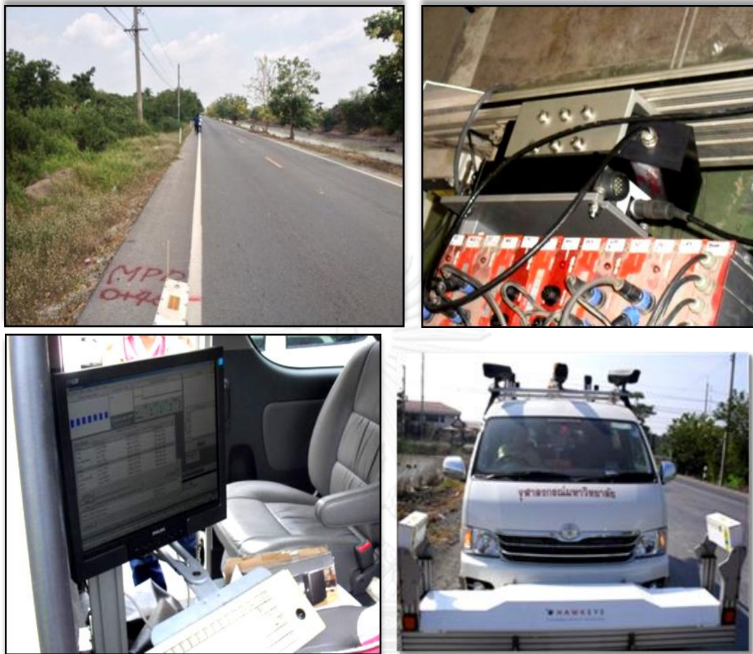
รูปที่ 3.2 ภาพการใช้เครื่องมือสำรวจ High-speed Laser Texture Measurement
