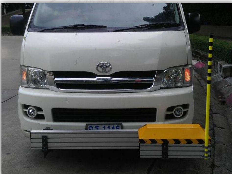
รูปที่ 2.5 ตัวอย่างการติดตั้ง High-speed Laser ที่ด้านหน้าของรถ (กรมทางหลวงชนบท, 2556)
