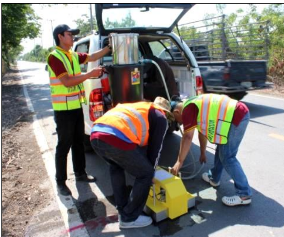
รูปที่ 3.5 การใช้งานเครื่องมือทดสอบค่าสัมประสิทธิ์ความเสียดทานของผิวทาง แบบแปรผันความเร็วชนิด Dynamic Friction Tester (DFT)
