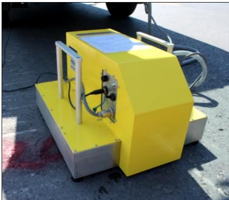
รูปที่ 3.4 เครื่องมือทดสอบค่าสัมประสิทธิ์ความเสียดทานของผิวทางแบบแปรผันความเร็วชนิด Dynamic Friction Tester (DFT)
