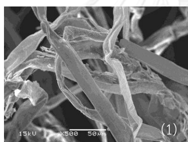
(ข) วัสดุตุ้ดซับขนุน+สารละลายกรดฟอสฟอริก 10% (1) ภาพพื้นผิวด้านข้างที่กำลังขยาย 500 เท่า (2) ภาพตัดขวางที่กำลังขยาย 5000 เท่า
