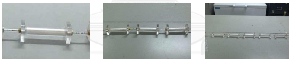
ภาพที่ 38 ตัวกลางดูดซับที่บรรจุในคอลัมน์ปริมาณ 1 3 และ 5 กรัม
