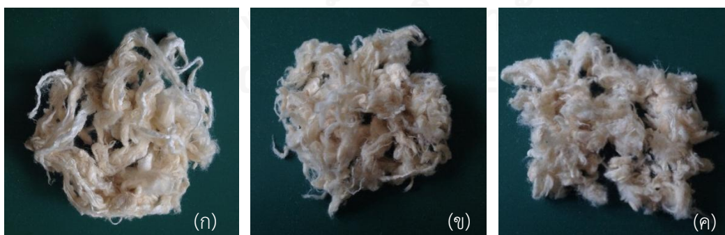
ภาพที่ 26 วัสดุดูดซับแบบผสมอัตราส่วนเส้นใยเรยอนต่อเส้นใยนุ่นเท่ากับ 1:1 เตรียมโดยใช้ความเข้มข้นของสารละลายกรดฟอสฟอริกต่างกัน (ก) 10% (ข) 30% และ (ค) 50% v/v
