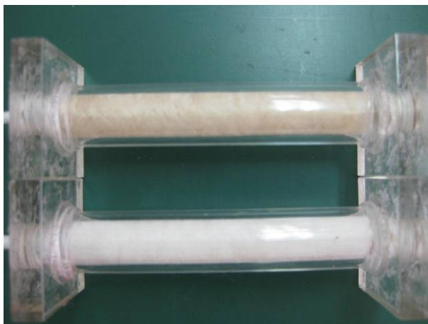
ภาพที่ ค.1 วัสดุดูดซับนุ่นและเรยอนที่เตรียมขึ้นปริมาณ 1 กรัมที่บรรจุภายในคอลัมน์
