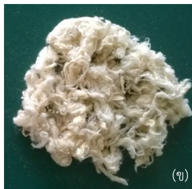
ภาพที่ 28 วัสดุดูดซับผสม (ก) เตรียมจากกรดซัลฟิวริก 10% (ข) เตรียมจากกรดฟอสฟอริก 10%
