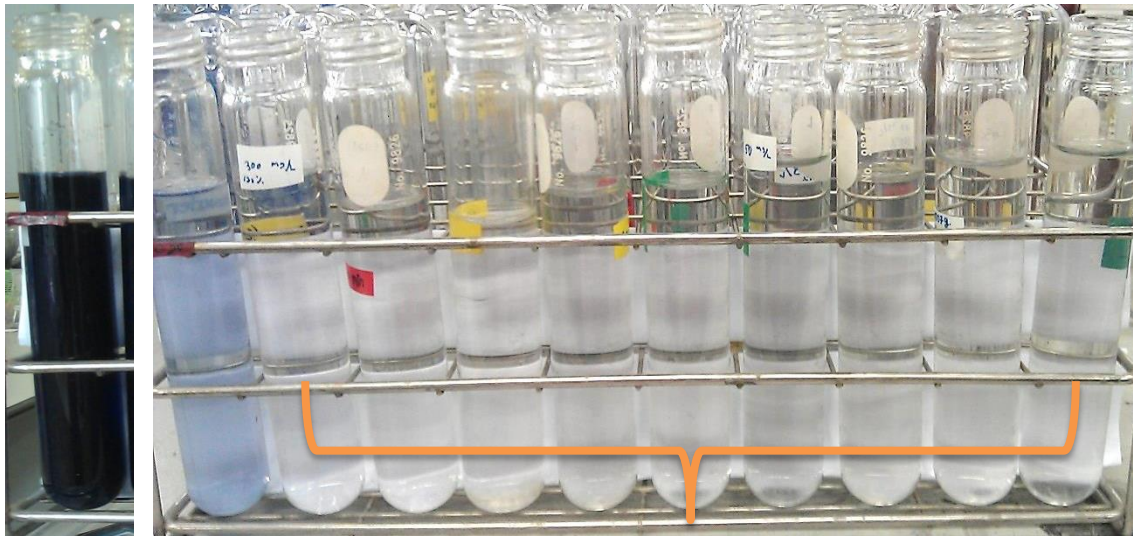
รูปที่ 4.23 น้ำเสียสีขุ่นที่ผ่านการบำบัดด้วยระบบไฮบริด ที่ Q=0.5 ล./นาที L_s=2.5 ก./นาที ความเข้มข้นสีขุ่น 150 มก./ล.
